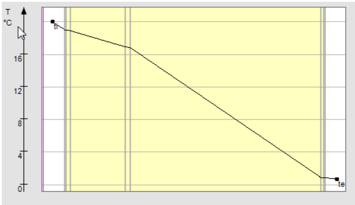
Rys. nr 35. Rozkład temperatur w przegrodzie projektowanej w grudniu.
